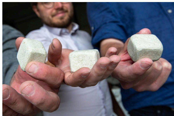
Les fossilisateurs de Néolithe transforment les déchets en une nouvelle matière, l'anthropocite.
