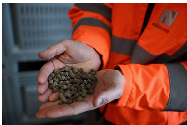
Beaulieu-sur-Layon, jeudi 20 février 2025. Mélangée à un liant minéral, la poudre de déchets est extrudée sous forme de granulats.
