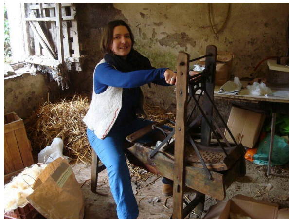
Une cardeuse à balancier, ou démêleuse.
